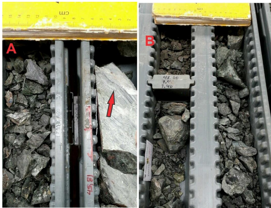
Figura 19 - A: Grafita muito fraturada e vênulas de grafita com falhas escalonadas; B: grafita muito fraturada em provável zona de falha.
