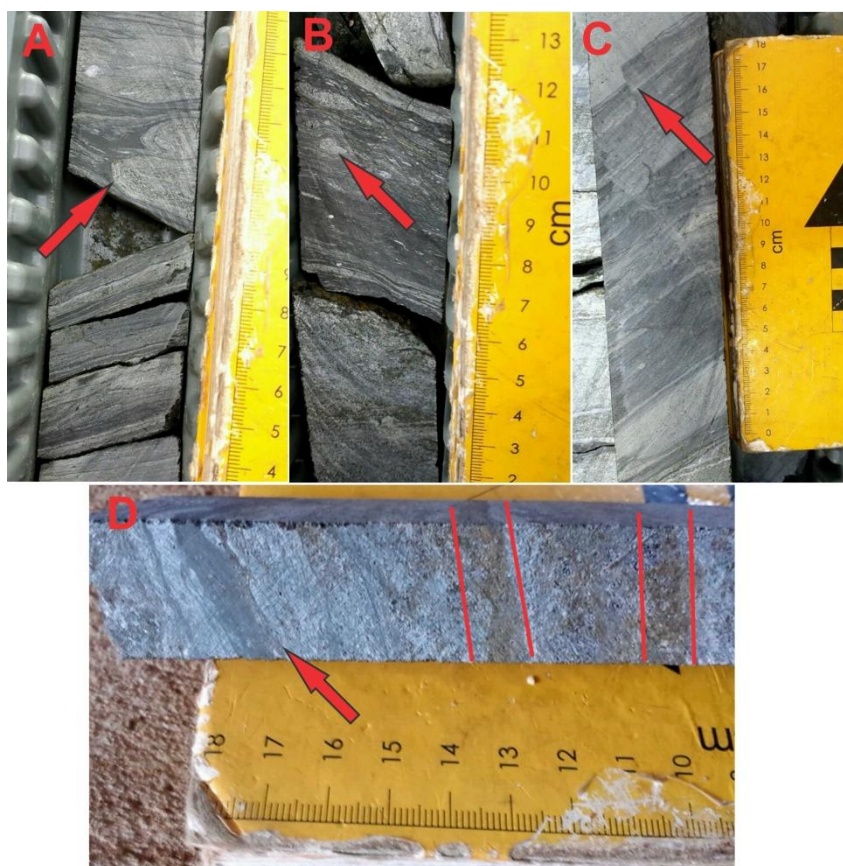
Figura 18 - A: Leitões de grafita associados com clorita (seta) ; B: porção de grafita com presença de porfiroclastos de quartzo (seta); C: lentes de grafita com falhas (seta); D: banda grafitosa (seta), próxima a bandas de sulfetos (linhas vermelhas).
